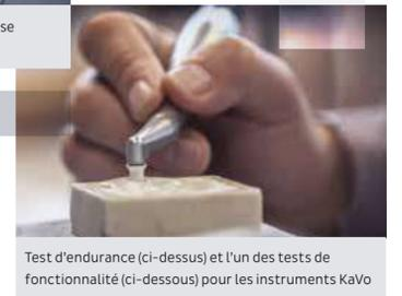
Test d'endurance (ci-dessus) et l'un des tests de fonctionnalité (ci-dessous) pour les instruments KaVo
