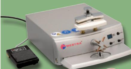
La soudeuse est contrôlée de manière électronique, ce qui élimine pratiquement les étincelles généralement produites entre les électrodes des machines sans régulation. La puissance compte 30 niveaux différents pour s'adapter précisément aux exigences requises par le type de matériau à souder ou par l'épaisseur de la chape ou de la plaque.
