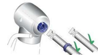
Grâce au système de serrage amélioré des modèles S201 L Pro et XL Pro, KaVo offre une réelle avancée en terme d'utilisation. En effet, le système hexagonal au niveau de la tête permet une distribution du couple sur une surface plus large lors du processus de vissage de l'implant.
